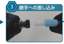
真っすぐに一気に挿入して下さい (斜め、回転、振り曲げ挿入禁止)
