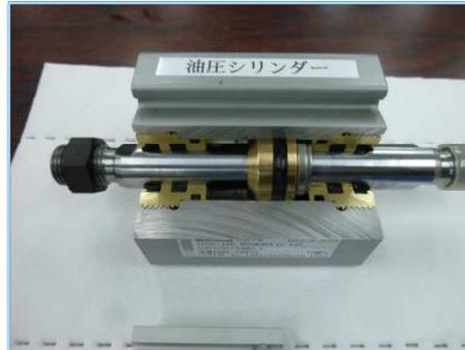
図5-30 油圧シリンダーのカットモデル
