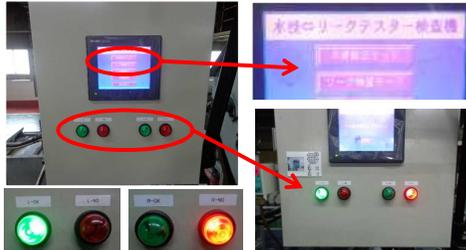
1. 右方向からのエア注入に対する漏れ検知を制御盤石のOK、NGランプで可視化。左方向も同様。
